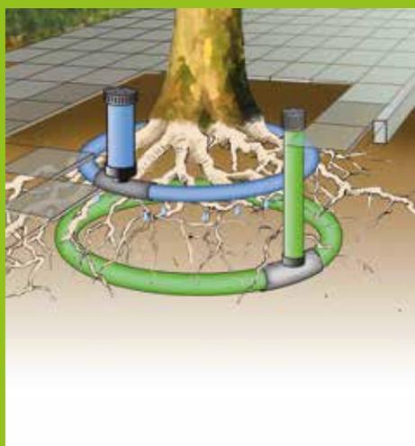
Viele (junge) Bäume, Sträucher und Hecken im urbanen Umfeld leiden unter Wasser- und/oder Sauerstoffmangel. Das AirMax Belüftungssystem und das AquaMax Bewässerungssystem sind dafür entwickelt worden, diese Missstände effizient zu verbessern und sind darüber hinaus sehr einfach zu installieren.
