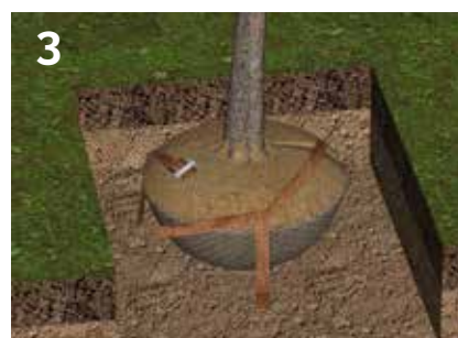
3 Verbind de 3 ankerbanden met 1 gordel inclusief ratel
