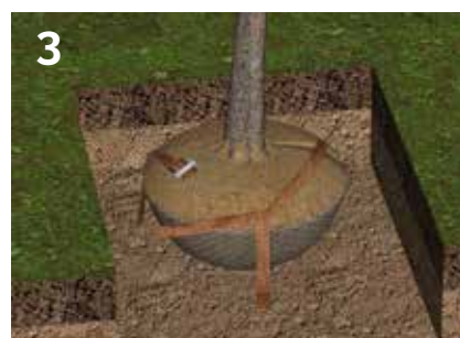
3 Verbind de 3 ankerbanden met 1 gordel inclusief ratel
