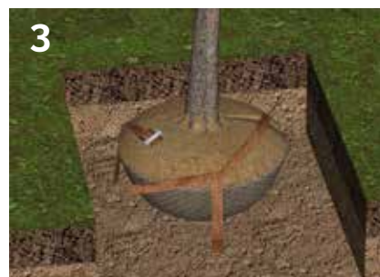
3 Verbind de 3 ankerbanden met 1 gordel inclusief ratel
