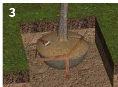
3 Verbind de 3 ankerbanden met 1 gordel inclusief ratel
