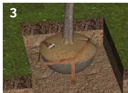
3 Verbind de 3 ankerbanden met 1 gordel inclusief ratel
