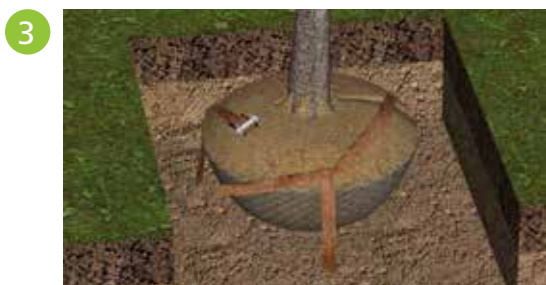
Verbinden der drei Ankerschlaufen mit der Ratsche des Spanngurtes
