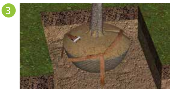
Verbind de 3 ankerbanden met 1 gordel inclusief ratel
