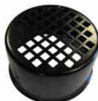
Eindkap thermisch verzinkt staal RAL 9005, gepoedercoat Ø 80 mm, staaldikte 1 mm Type: AMROND80
