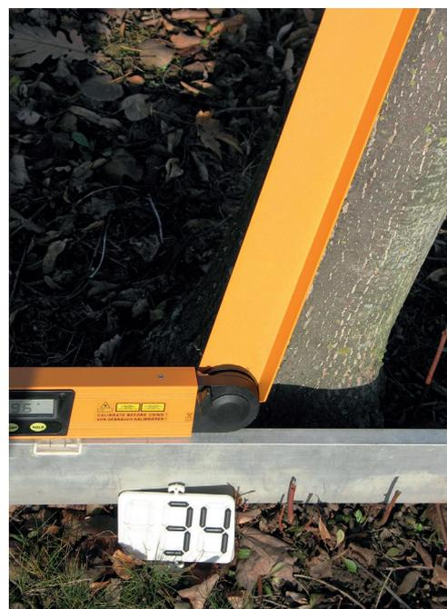
**Abbildung 6: Messung der Stammneigungswinkel mit dem „Multi-Digit pro“**
